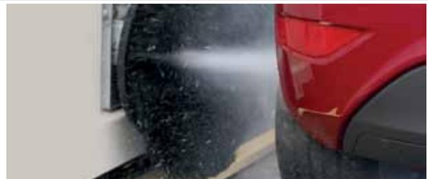
Die neue, in der Radwaschanlage integrierte rotierende 80 Bar-Hochdruckanlage ermöglicht eine Anwendung auf den Felgen sowie über die gesamte Fahrzeuglänge. Durch die doppelte Drehrichtung werden bei den neuen Felgen-Designs bessere Ergebnisse erzielt.
