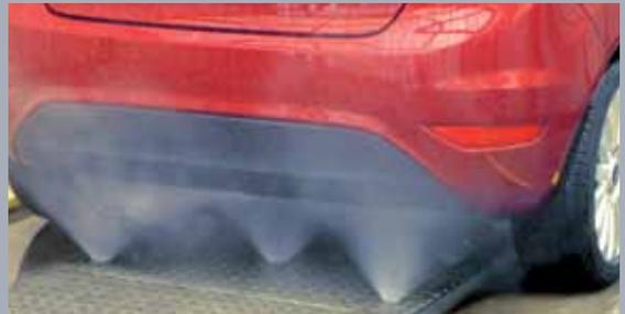
Das perfekte Zubehör, um selbst dem anspruchsvollsten Ihrer Kunden die vollkommenste Wäsche anzubieten. Sie können wählen zwischen: UBW star 10 Bar, 90 L/Min., UBW oszillierend 15 Bar, 120 L/Min. oder UBW nach Sektoren 15 Bar, 120 L/Min.
