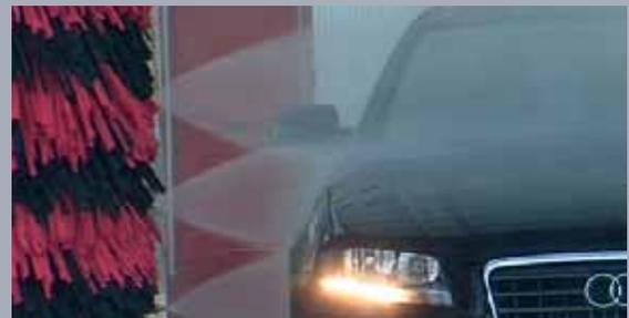
Diverse Hochdruck-Optionen bereiten das Fahrzeug für ein besseres Waschergebnis durch die Walzenwäsche vor. Wählen Sie zwischen folgenden Versionen aus: 15 Bar und 120 L/Min., 80 Bar und 42 L/Min. oder 80 Bar und 84 L/Min.
