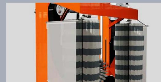
Mikroperforierte Planen für den Schutz gegen evtl. bei der Wäsche auftretende Spritzer.
