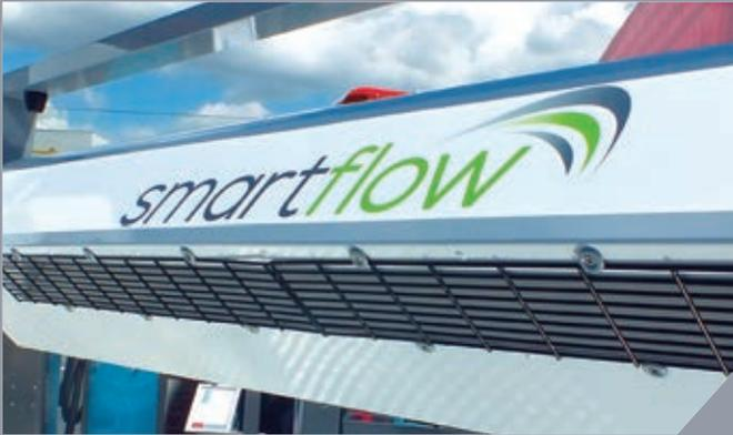
Abgesehen von der kompletten Trocknung (seitlich+ oben konturfolgend), kann FLEX5 auch mit dem neuen, von ISTOBAL patentierten Dach-Trocknungssystem Smartflow ausgerüstet werden, um den Stromverbrauch und die Lärmemissionen drastisch zu reduzieren.
